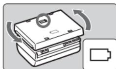
Si se ha recargado la batería, coloque la tapa de modo que el orificio con forma de batería <
