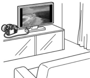
Utilice el cable AV que se proporciona o un cable HDMI HTC-100 (se vende por separado) para conectar la cámara a un aparato de TV. Así podrá reproducir los vídeos grabados y las fotos en el aparato de TV.
