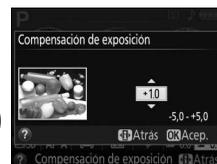
La exposición normal puede volver a restaurarse ajustando la compensación de exposición a  $\pm 0$ . La compensación de exposición no se restaura al apagar la cámara, aunque se restaurará si selecciona otro modo tras la selección de
