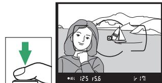
No cambie la distancia entre la cámara y el sujeto mientras el bloqueo del enfoque esté activado. Si el sujeto se mueve, vuelva a enfocar a partir de la nueva distancia.
