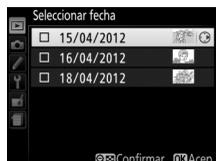
Para visualizar las imágenes realizadas en la fecha marcada, pulse **Q** (?). Utilice el multiselector para desplazarse por las imágenes o mantenga pulsado el botón **Q** para visualizar la imagen actual a pantalla completa. Pulse **Q** (?) para regresar a la lista de fechas.
