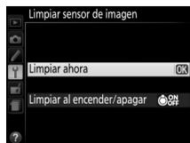
La cámara comprobará el sensor de imagen y, a continuación, comenzará la limpieza. **b5y** parpadeará en el visor y no podrá realizar ninguna otra operación. No extraiga o desactive la fuente de alimentación hasta completar la limpieza y hasta que el mensaje indicado a la derecha ya no sea visualizado.
