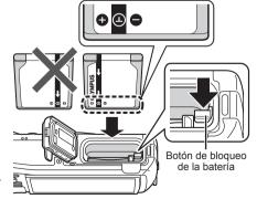
la batería en la dirección de la flecha para desbloquear la batería, y a continuación extráigala.
